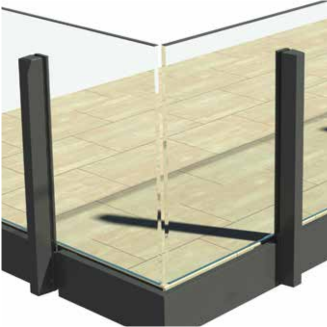
Montageprobleme im Eckbereich - gelöst durch seitlichen Glasüberstand
